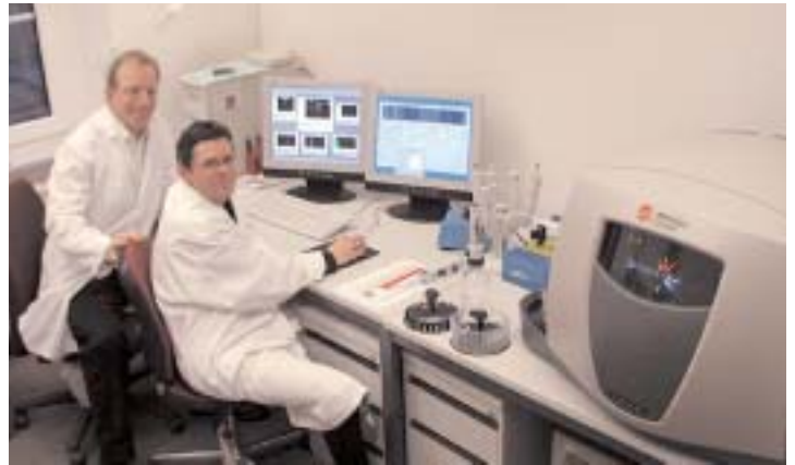
Die ETH-Forscher Joachim Fischer (links) und Adrian Urwyler untersuchen mittels Laser die Blut-Proben der ETH-Mitarbeiter im 150'000-fränkigen Durchfluss-Zytophotometer (rechts) auf biologische Zeichen der Stressreaktion. BILD: JAKOB LINDENMEYER
